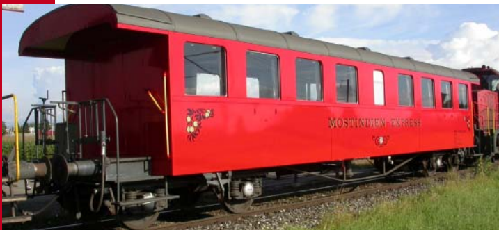
Der Personenwagen C 111 «Mostindien-Express» basiert auf SBB-Wagen aus dem Jahr 1907 der Schweizerischen Waggonfabrik Schlieren SWS. Nach dem Umbau zum 4-achsigen Prototypen gelangte er 1966 zur MThB und wurde später zum roten Salonwagen ausgebaut.
