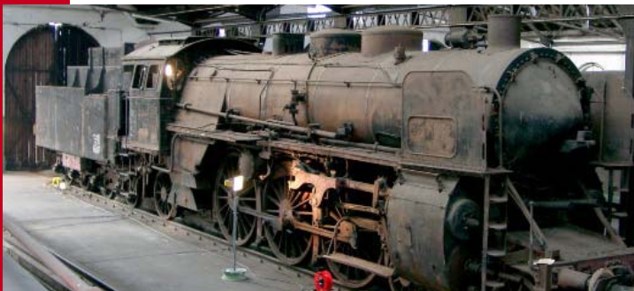
Die letzte betriebsfähige Thurgauer Dampflokomotive (M.Th.B. Ec 3/5 Nr. 3) wurde 1912 von der Schweizerischen Lokomotiv- und Maschinenfabrik SLM Winterthur zusammen mit 3 Schwesterloks speziell für die Anforderungen der kurvigen und steigungsreichen Strecke der Mittel-Thurgau-Bahn gebaut.
